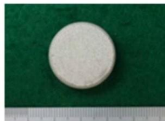
水ガラス/Gd 2 O 3 造粒粉材(硬化後)
