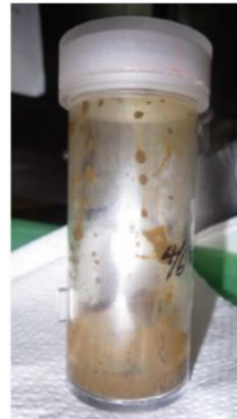
1号機格納容器底部堆積物
