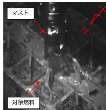
マストと配管の干渉により 吊ることができない燃料 (No.⑭※)
