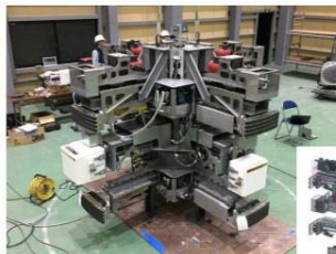
筒身解体装置 組立状況
