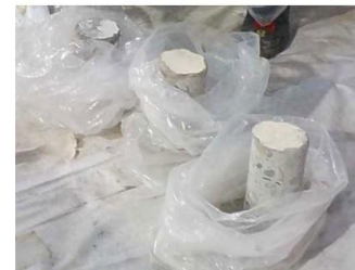
調査用コア採取状況
