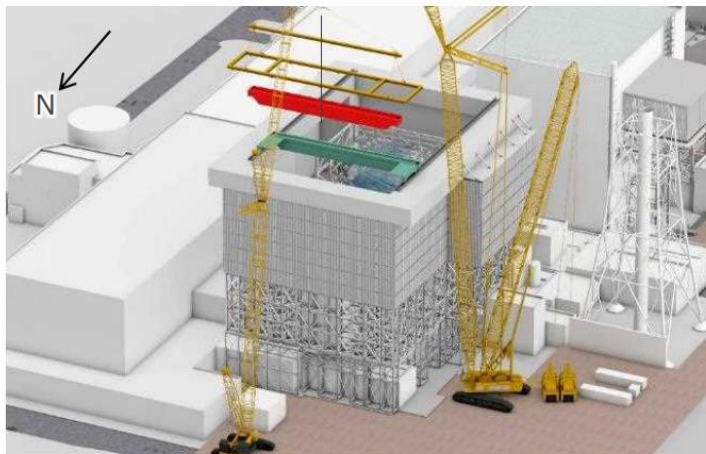
ガレキ撤去用天井クレーン設置中
