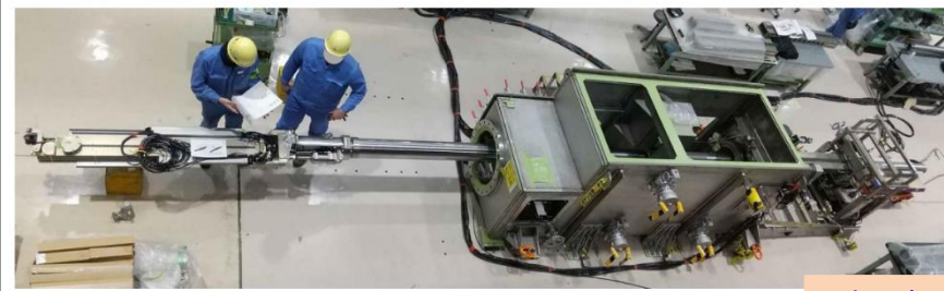
テレスコピック試験的取り出し装置 (装置を上方から撮影)
