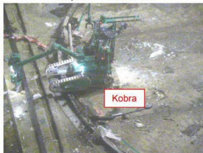
④低所表面汚染測定状況
