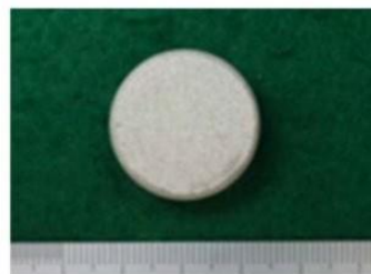
水ガラス/Gd 2 O 3 造粒粉材(硬化後)
