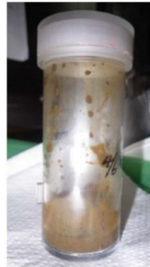
1号機格納容器底部堆積物
