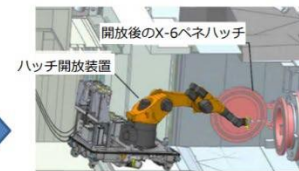
ハッチ開放装置による X-6ペネハッチ開放
