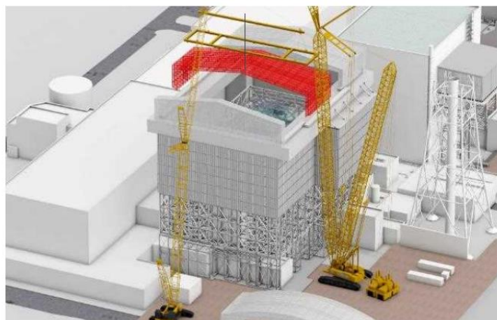
可動屋根設置中
