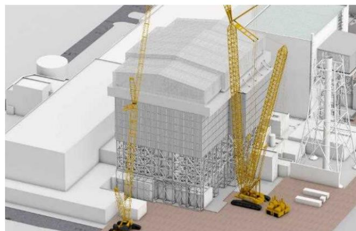
可動屋根設置完了
