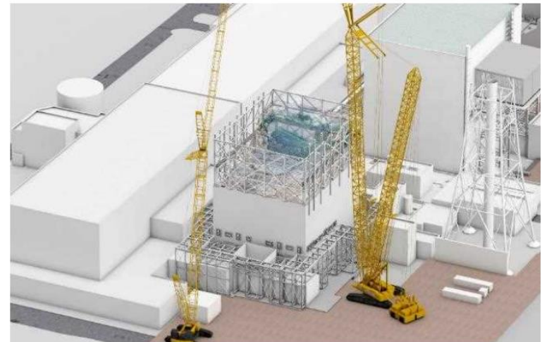
仮設構台設置完了
