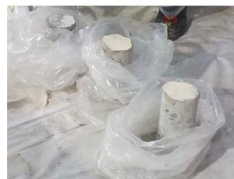
調査用コア採取状況
