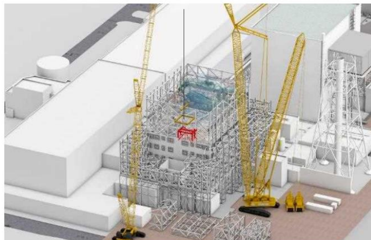
下部架構設置中
