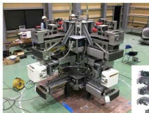
筒身解体装置 組立状況
