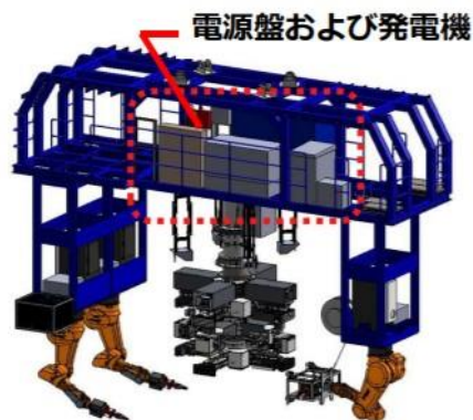
筒身解体装置 外観
