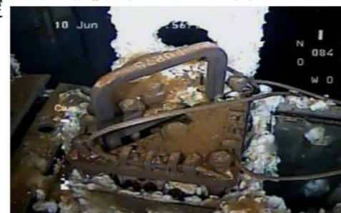
ワイヤー修復燃料上部の様子
