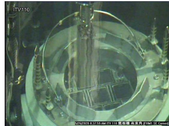
使用済み燃料の輸送容器への装填状況
