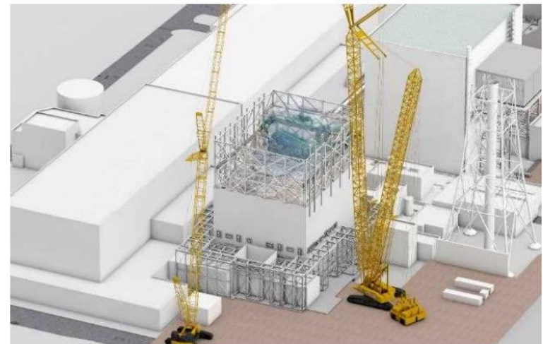
仮設構台設置完了
