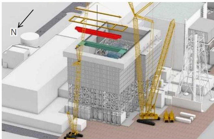
ガレキ撤去用天井クレーン設置中
